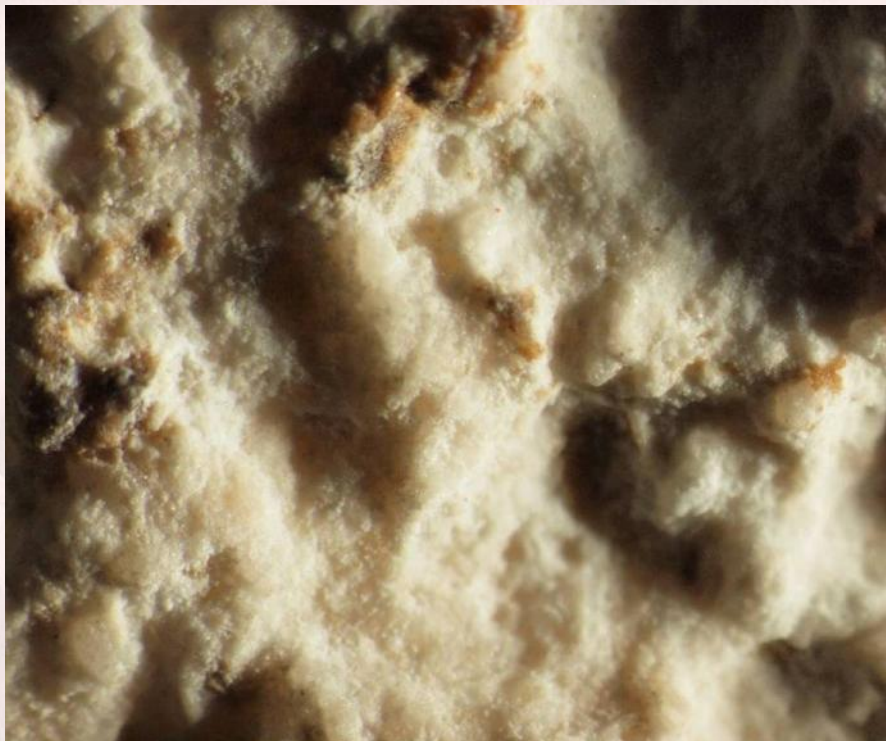
Snimak površine kamena na svjetlosnom mikroskopu pri uvećanju od P=100X
