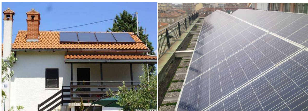
Slika 4 Primjeri korištenja Sunčeve energije: sunčani toplinski kolektori (lijevo) i fotonaponski moduli (desno)
